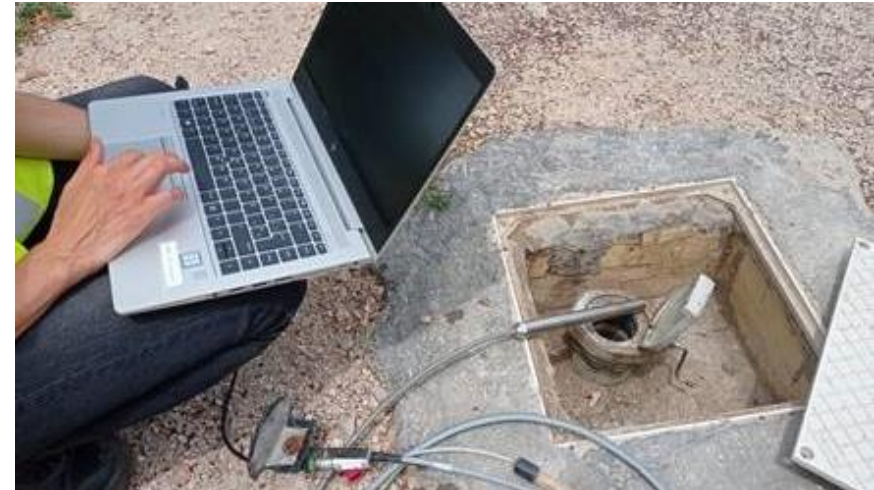
Imagen 39. Descarga de datos de información piezométrica.
