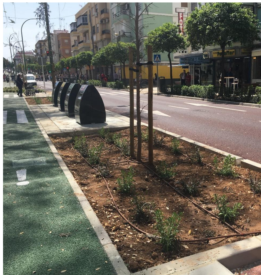
Imagen 11. Pavimentos permeables y zona de biorretención en Sevilla. Fuente: EMASESA.
