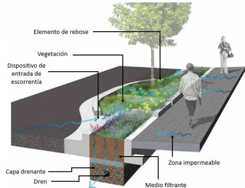
Figura 9. Esquema de un parterre inundable. Fuente: Adaptado de Washington DC Department of Transportation (2014).
